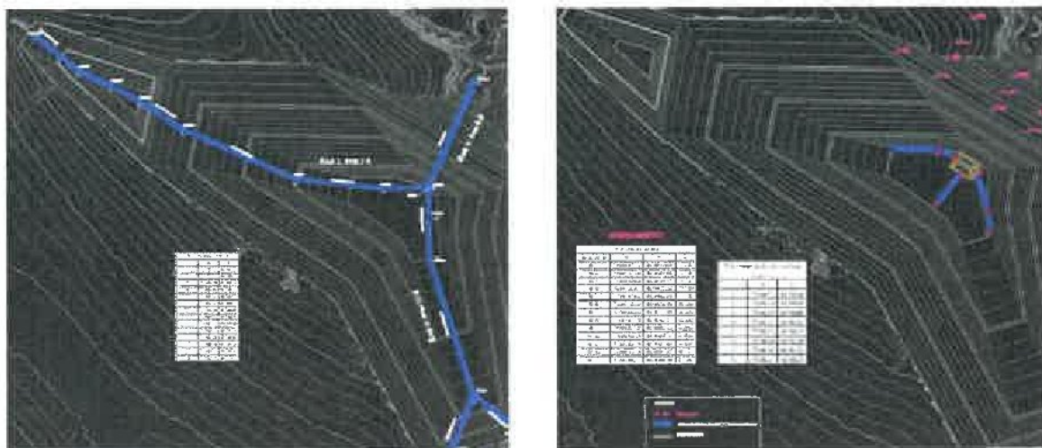
Slika 38 Drenažni sistem ispod HDPE geomembrane
